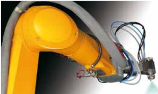
Die PILOT WA 905 ist optimal zum Einsatz an Robotern geeignet.
