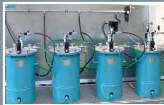
**2-Komponenten-Misch- und Dosieranlage WAGNER FlexControl plus XL. Die FlexControl plus XL ist extrem leistungsstark und für den Einsatz mehrerer Pistolen ausgelegt. Steuerteil und Fluidteil sind getrennt. Die Förderung der einzelnen Komponenten und des Härterers erfolgt in diesem Fall ausschließlich über Druckbehälter.**
