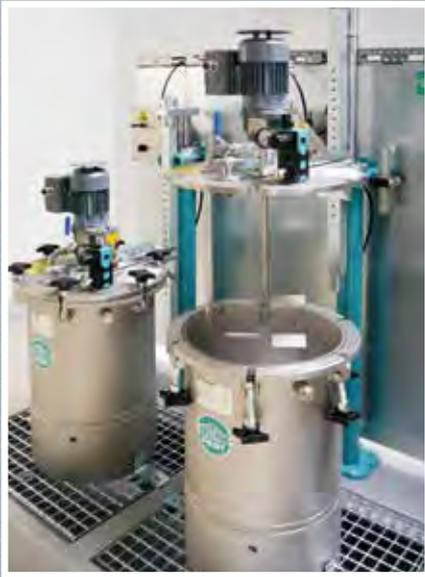
Farbversorgung mit Hubeinrichtung für Druckbehälterdeckel und Elektrorührwerken.
