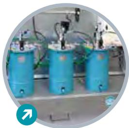
Die Materialzuführung kann über Membran- oder Kolbenpumpen bzw. Druckbehälter erfolgen.
