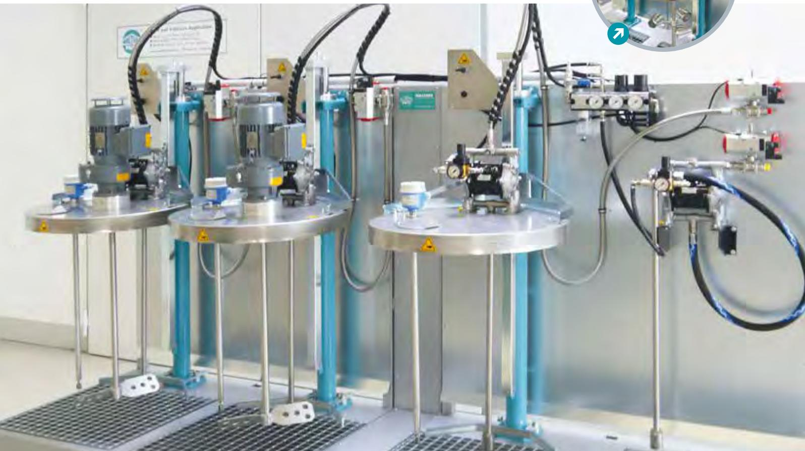
Materialförderanlage für ein 2-Komponenten-Dosier- und Mischsystem. Die Anlage ist mit Elektrorührwerken und mit Deckelhubeinrichtungen zum schnellen Austausch von 200-Liter Fässern versehen.
