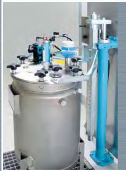
Heizmantel-Druckbehälter mit Deckelhubeinrichtung, Druckluft-Rührwerk, Füllstandssonde.
