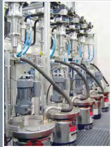
Farbförderanlage mit Deckelhubeinrichtungen für Hobbocks, Elektrorührwerken und Wagner Kolbenpumpen.
