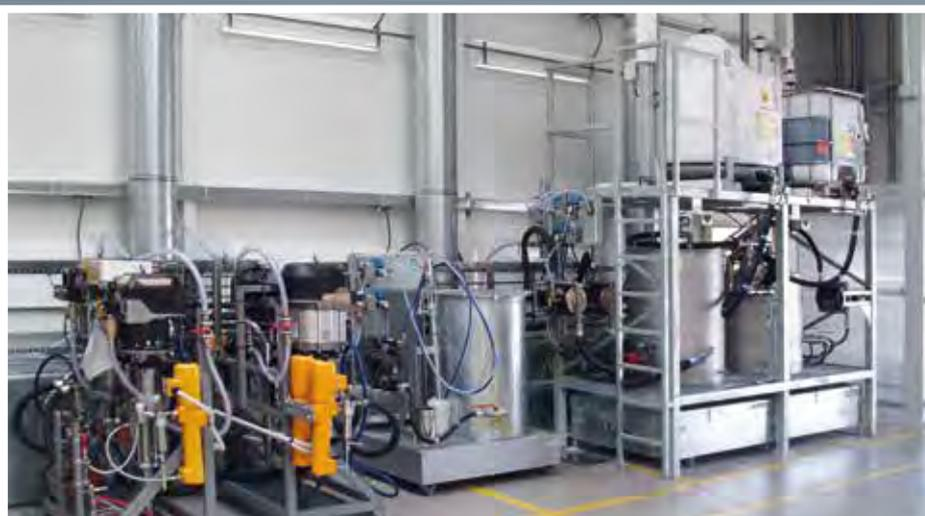
Anlage für die Förderung von Unterbodenschutz für Nutzfahrzeuge. Das Material wird im WALTER Arbeitsbehälter über eine eingebaute Warmwasserheizung fließfähig gemacht. Für die Materialzufuhr zur 2K-Dosierstation werden für beide Komponenten elektrisch beheizte Schläuche eingesetzt. Die Hochdruck-Leistungspumpen der Wagner „Twin“ Dosier- und Mischanlage sind mit Materialerwärmern bestückt.
