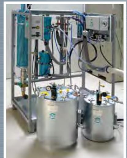
Systembeispiel für Zweikomponenten-Farbspritzanlage mit festeingestelltem Mischungsverhältnis und beheizbaren Druckbehältern.
