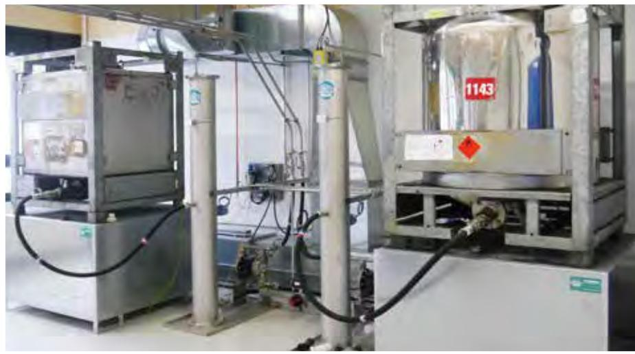
**Abfüllanlage:** Die beiden entzündlichen Komponenten werden in Containern angeliefert und zur Mischanlage gefördert. Vom WALTHER PILOT FMB 1000 gelangt die fertige Mixtur zur Abfüllstation.
