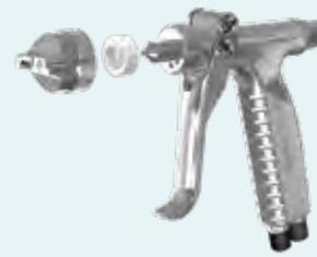
Zum Lieferumfang der PILOT TWIN gehören zwei Kunststoffringe. Diese setzen Sie ein, wenn Sie die Spritzstrahlbreite verringern möchten. Somit können Sie den Materialverbrauch entscheidend senken. Der Einbau der jeweiligen Ringe ist binnen Sekunden möglich.
