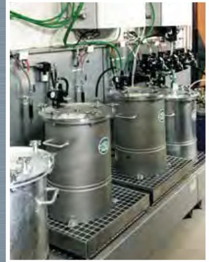
**Zentrale Lackversorgung mittels Druckbehälter bzw. Membranpumpen. Sowohl für die Grundierung als auch für den Decklack werden 2K-Systeme eingesetzt. Die Dosierung und Mischung erfolgt elektronisch über eine Flex-Control Plus Zwei-Kreis.**
