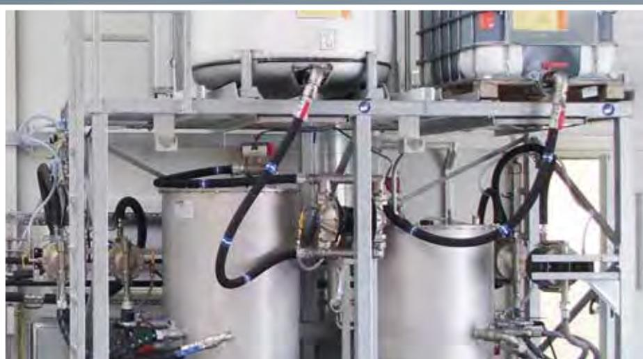
**Bei besonders zähflüssigen Medien** werden statt Containern sog. Fluid Bags eingesetzt. Vom Fluid Bag (Stammkomponente) und vom Container (Härter) gelangt das Material zu den WALTHER PILOT FMBs. Dort wird es durch Erwärmung fließfähiger gemacht.
