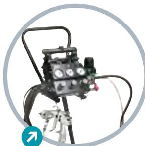
SprayPacks mit Membranpumpe, Materialfilter/Pulsationsdämpfer beziehen Sie ebenfalls von uns.
