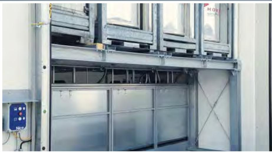
**Schwerlast-Containergestell.** Die Container werden von außerhalb in die vorgesehene Position gebracht.
